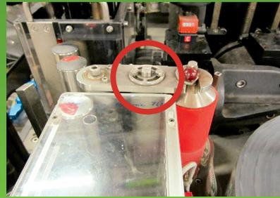
**Après :** Dans le cadre d'un Kaizen "défaut boucle", création d'un système de réglage automatique (avec un ressort), qui s'adapte à l'épaisseur de la bande et qui compense l'usure du rouleau => éradication d'un réglage.
