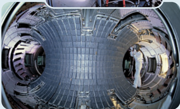
Chambre à vide de TORE SUPRA dans laquelle circule le plasma lors des essais
