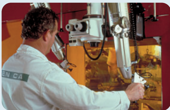
Télémanipulation de combustibles irradiés isolés dans une cellule protégée
