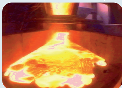
Expérience d'écoulement de corium pour la maîtrise de situations accidentelles
