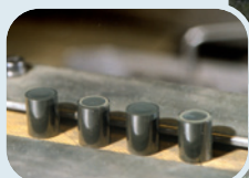
Pastilles de combustible nucléaire utilisées actuellement (mélange d'oxydes d'uranium et de plutonium)
