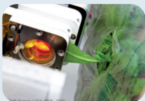
Mesure d'échanges gazeux sur une feuille d'Arabidopsis
