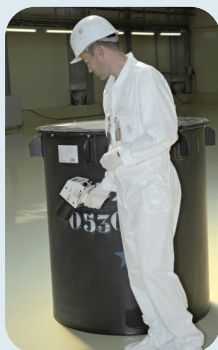
Contrôle radiologique sur un colis de déchets de faible activité
