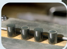
Pastilles de combustible nucléaire utilisées actuellement (mélange d'oxydes d'uranium et de plutonium)
