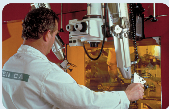
Télemanipulation de combustibles irradiés isolés dans une cellule protégée
